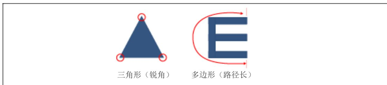
图 2-8. 不合适的电极形状
